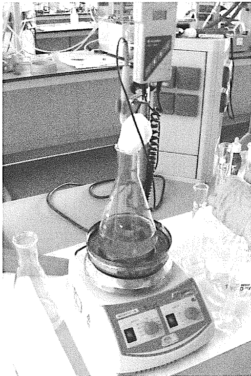
Figura 5: Agitador magnético con la mezcla de aceite en reacción.
